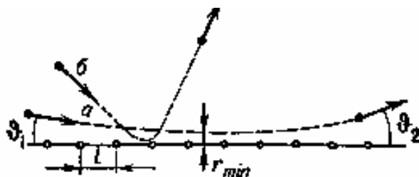
Рис. 5.7. Траектории заряженных частиц в кристалле при угле падения на грань кристалла \theta_1 < \theta_L (кривая a ) и при \theta_1 > \theta_L (кривая б )
